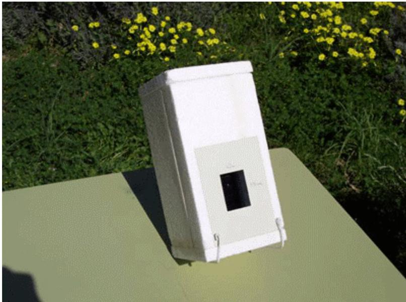
Para compensar el efecto de la rotación terrestre, se ha de reenfocar el calorímetro cada 5 o 10 minutos, la sombra de la caja puede servir de guía.
