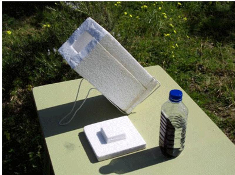
El soporte se hace con un alambre fuerte, doblándolo con los alicates hasta conseguir un trípode capaz de sostener inclinada la caja, de tal forma que la cara con la ventanilla quede enfocada perpendicularmente al Sol.
