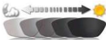
La lente fotocromática es sensible a los cambios de luz, así se oscurece conforme aumenta la intensidad de la luz exterior y se aclara cuando ésta incide menos.
