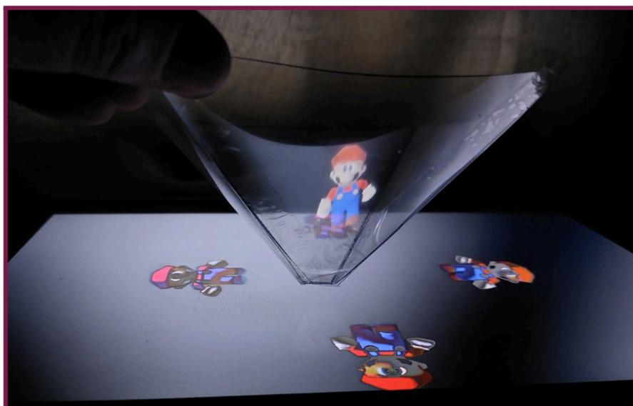
La explicación del funcionamiento está relacionado con conceptos de Física, relacionados con la reflexión de la luz. Los hologramas se ven “dentro” de la pirámide porque al reflejarse la luz y la imagen en el acetato que está a una inclinación de 45 grados, se crea una imagen virtual “detrás” del acetato también a 45 grados, como si fuera un espejo.
