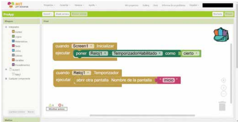
Fig. 4: Panel de programación de la transición de la presentación de ProApp. Captura de pantalla realizada en computadora que contiene los siguientes elementos: Nombre de la pantalla de presentación (Screen1), nombre del reloj insertado en dicha pantalla (Reloj1), nombre de la pantalla que contiene el menú principal (inicio). Fuente: Elaboración propia.
