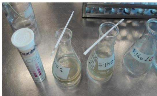
*Figura 16.* Determinación de nitritos y nitratos.
