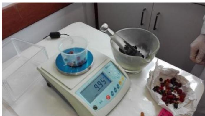
*Figura 2.* Preparación de las muestras para medir pH.
