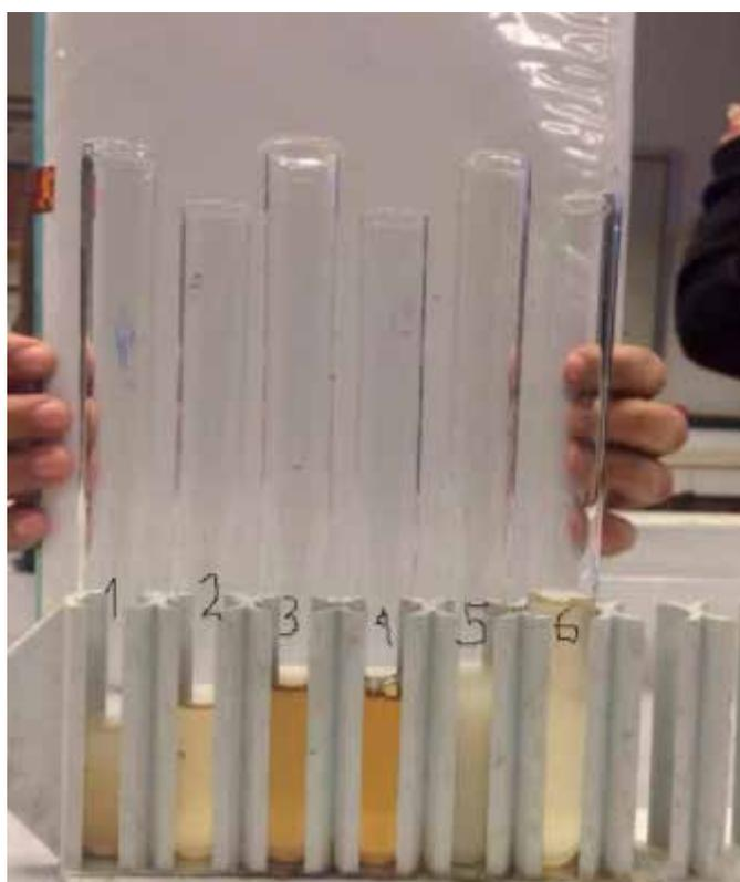
*Figura 7.* Soluciones con tubos testigos 2, 4, 6. Los tubos 1, 3 y 5 con soluciones de Coca Cola y oxalato de amonio.
