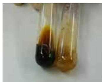
Ilustración 11: Comparación de la solubilidad de las muestras en NaOH 1,0 mol/L
