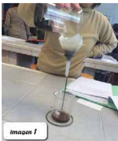
Figura 8. Filtrando la solución para emplearla en el polarímetro. Fotografía del 12 de setiembre
