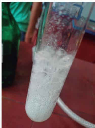
En este tubo se observa, también, la efervescencia que se produce al agregar el ácido clorhídrico.
