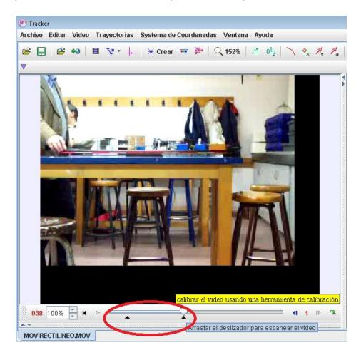
El siguiente paso es colocar una escala que permita tomar medidas comparativas en el vídeo, para eso se utiliza una herramienta que introduce un segmento ajustable (Vara de Calibración) al cual se le define un valor representativo para hacer las mediciones posteriores.
