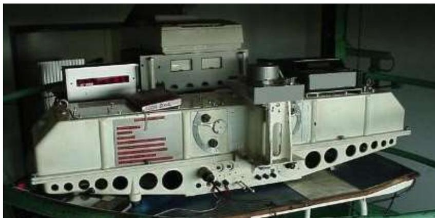
Ilustración 3 - Espectrofotómetro tipo Dobson usado en Salto
