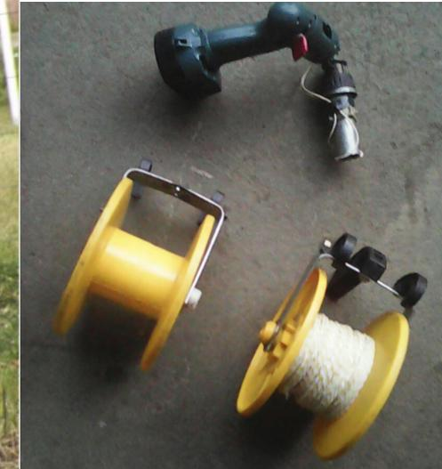
Se concluyó que este nuevo diseño ergonómico de carrete de bajo peso logra mayor practicidad y al ser el motor desmontable, con batería recargable, se puede recoger más de una hebra el cual reduce también el tiempo para realizar dicha tarea.
