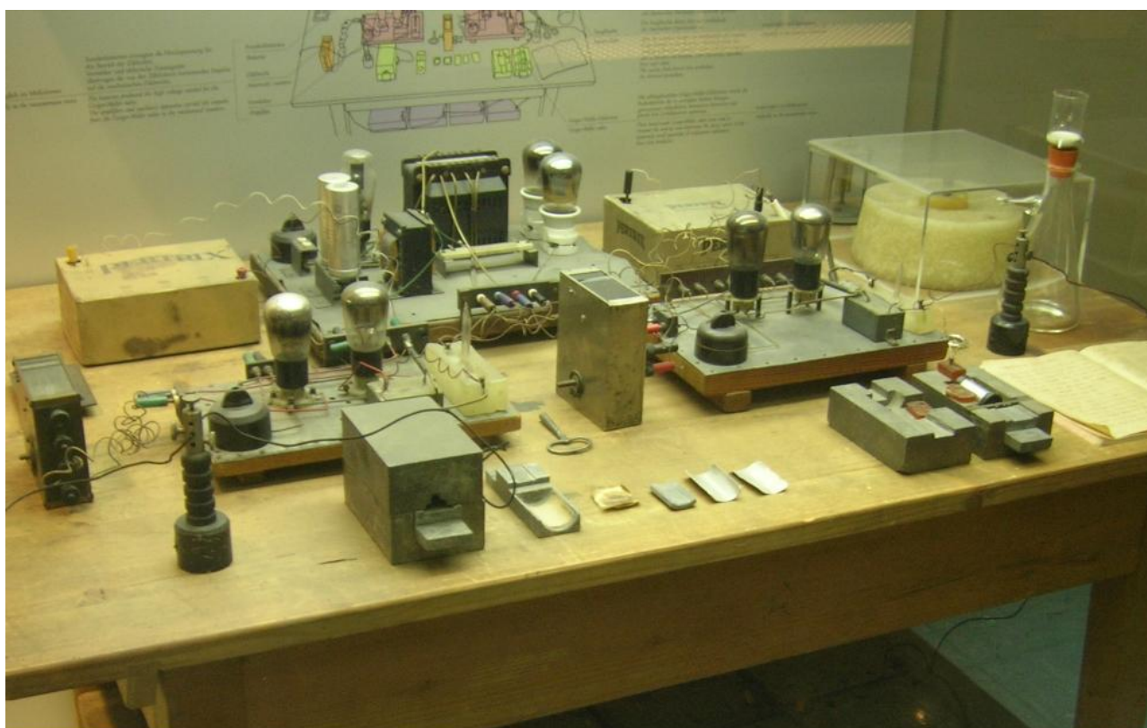
Dispositivo experimental con el cual Otto Hahn y Fritz Strassmann descubrieron la fisión nuclear en 1938 (Deutsches Museum - Munich. Fotografía tomada por Jacopo Werther)
